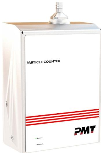
Die PoE-Partikelzähler 9301P und 9501P messen in einem Bereich von 0,3 bis 25,0  $\mu\text{m}$  bei einer Durchflussrate von 0,1 CFM (2,83 LPM). Diese Partikelzähler ermöglichen eine effiziente Partikelzählung mit Spezifikationen, die die Kalibrierstandards ISO 21501-4 und JIS B9921 erfüllen.
