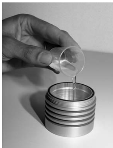
Abb. 2.2 Die korrekte Menge deionisiertes Wasser in das Gefäß füllen; den Messbecher anschließend trocknen
