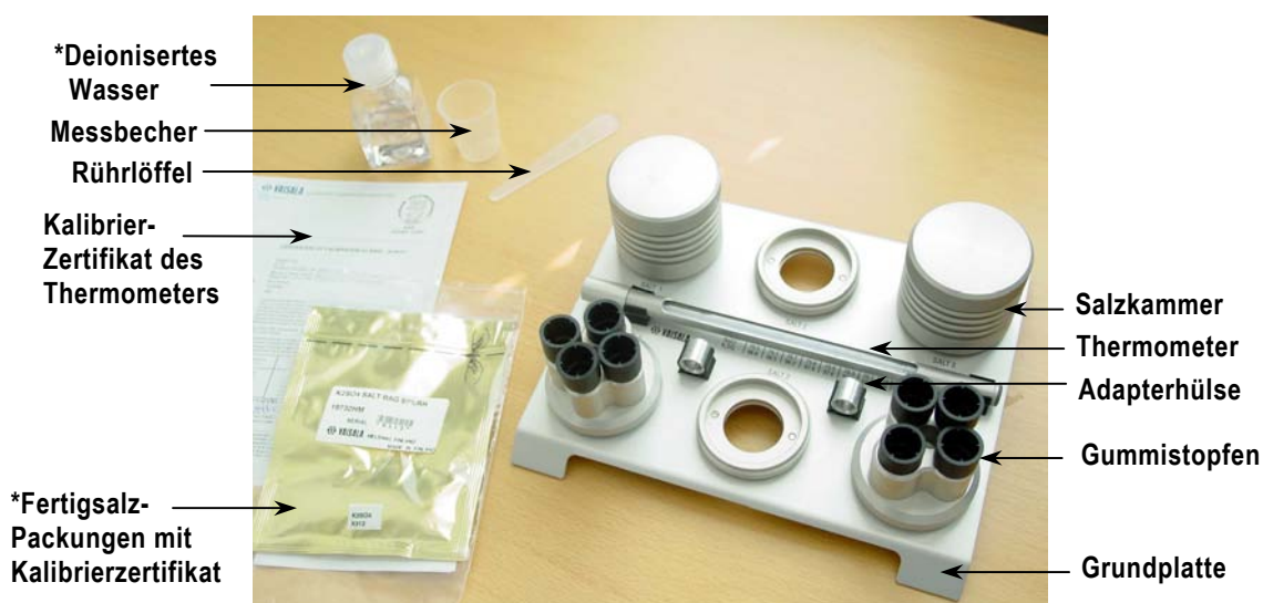
Abb 1.1 Der Kalibrator HMK15 und einige Zubehörteile*
