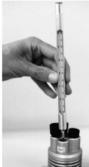
Abb. 3.3 Während der Kalibrierung wird das Thermometer in die 13,5 mm große Öffnung gesteckt
